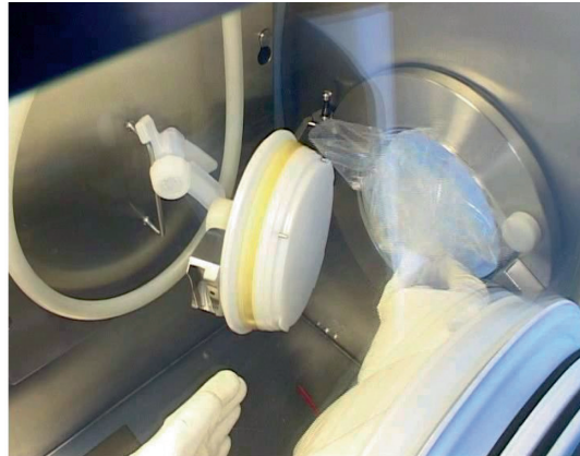
Abb. 3: Arbeiten mit „RTPs“ [9]. Links: Geschlossener Transport des RTP-Behälters zur Andockung am Isolator des Reaktors; Doppelklappe getrennt; nicht kontaminierte Innenseite derselben exponiert. Rechts: Befüllung in der Handschuhbox; Doppelklappe ungetrennt; nicht zu kontaminierende Innenseite derselben nicht exponiert; Zugang zum RTP-Behälter offen.
