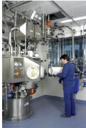
Abb. 3: Arbeiten mit „RTPs“ [9]. Links: Geschlossener Transport des RTP-Behälters zur Andockung am Isolator des Reaktors; Doppelklappe getrennt; nicht kontaminierte Innenseite derselben exponiert. Rechts: Befüllung in der Handschuhbox; Doppelklappe ungetrennt; nicht zu kontaminierende Innenseite derselben nicht exponiert; Zugang zum RTP-Behälter offen.
